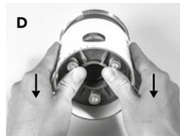
**Abbildungen C und D:** Legen Sie die Mockmill mit dem Flansch nach unten (siehe Bild). Fassen Sie das Gehäuse beidseitig auf Höhe der Schrift und drücken Sie mit dem Daumen gegen die Seite mit den drei Federn. Entfernen Sie das Gehäuse.
