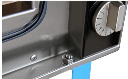
6. Exzenterbolzen einsetzen
