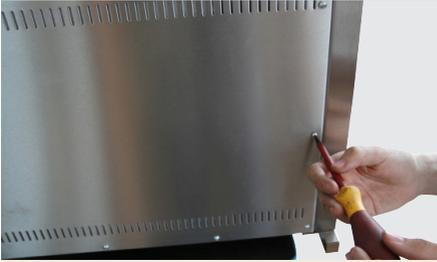
3. Seitliche Schrauben lösen
