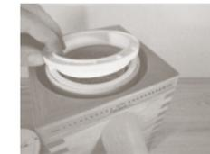
5. Plexiglaszylinder auf den Unterteil des Siebaufsatzes aufsetzen, dabei rasten die 2 Kugeln in den Vertiefungen am Zylinder ein, dazu eventuell den Zylinder etwas drehen.
